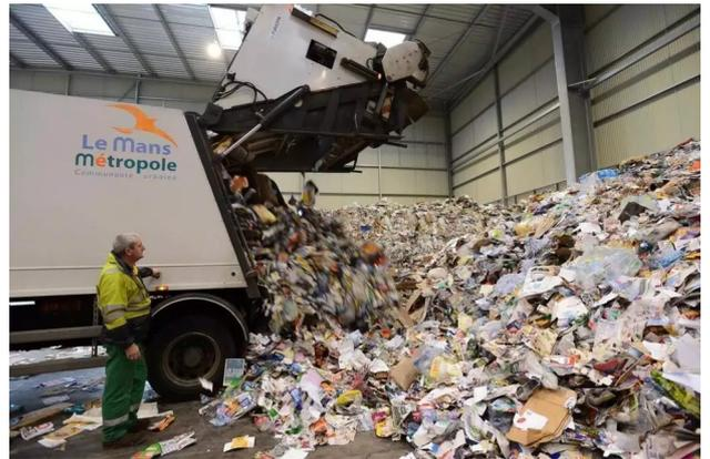
Les déchets sont d'abord tous déposés dans un grand entrepôt, puis une pelleteuse les prend pour les mettre dans une machine qui va séparer :
