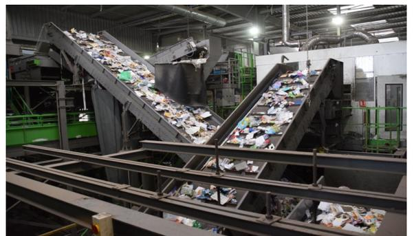
Pour les corps plats, ils vont être aussi séparés grâce à un jet d'air. Le carton, trop lourd pour le jet d'air, ne va pas voler alors que le papier si.
